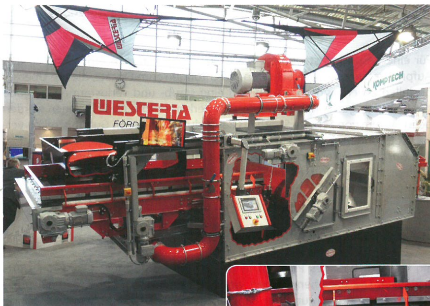
Einblick in den Westeria-Windsichter und auf den Bildschirm der neuen Steuerung
