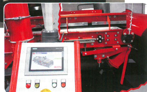
Einblick in den Westeria-Windsichter und auf den Bildschirm der neuen Steuerung
